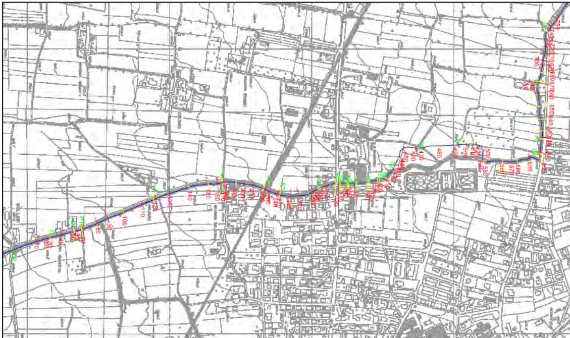
Figura 26 – Area di studio, con le sezioni implementate nel modello monodimensionale sul rio Levesa, su base CTP: tratto dal confine con Oglianico alla frazione Bolleri.
